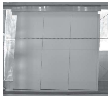
自社層間変位試験機での試験
