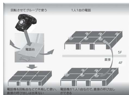
図2 ビルへの自営交換システム導入
