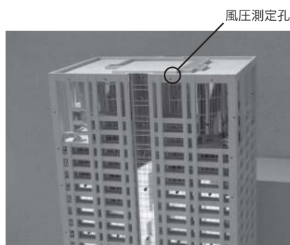
写真2 風圧実験の模型
