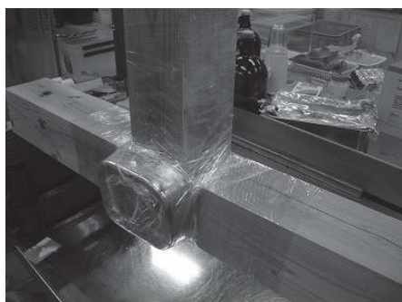
写真5 接合部への木材腐朽菌の設置
