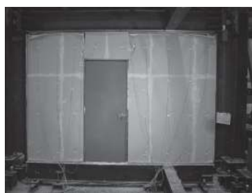
写真1 載荷後の扉付き壁試験体（北面）
