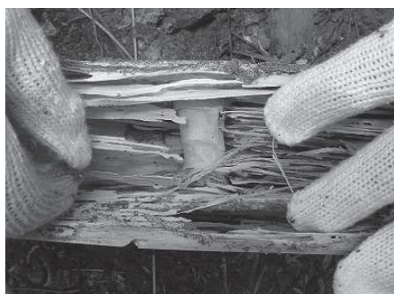
写真4 食害が激しく、試験に供することができなかった試験体
