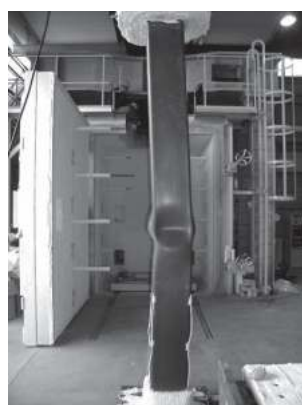
写真1 座屈後の試験体状況例
