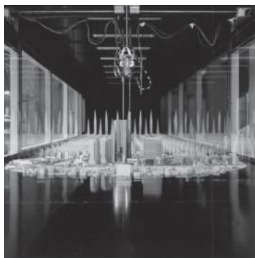
写真1 建築物の風洞実験の様子
