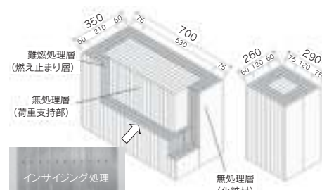
図2 「FRウッド」の概要（大断面と小断面）
