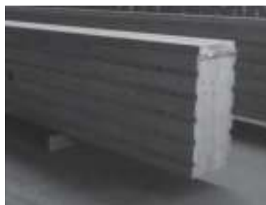
写真3 燃エンウッド製作 (梁)
