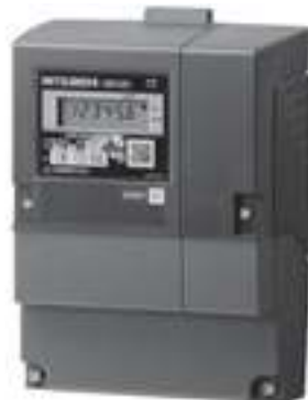
図1 スマートメーター外観
