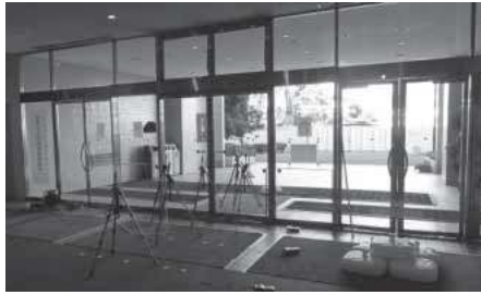
図2 一重扉の外気侵入状況実測
