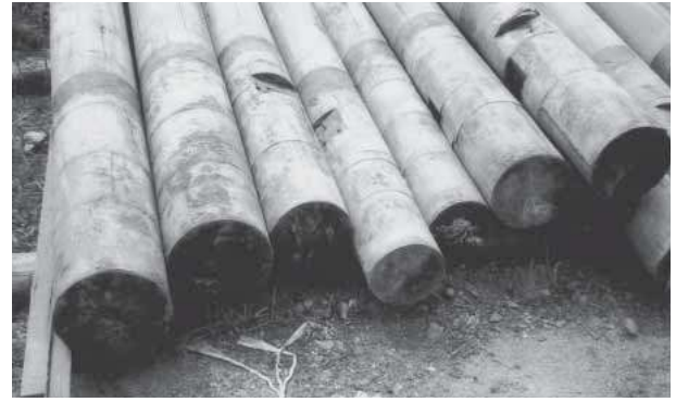
↑ 5. 園相神社の柱（平成 7 年）。底面以外の柱根は銅板で被覆されていたので、全く腐食していない。
