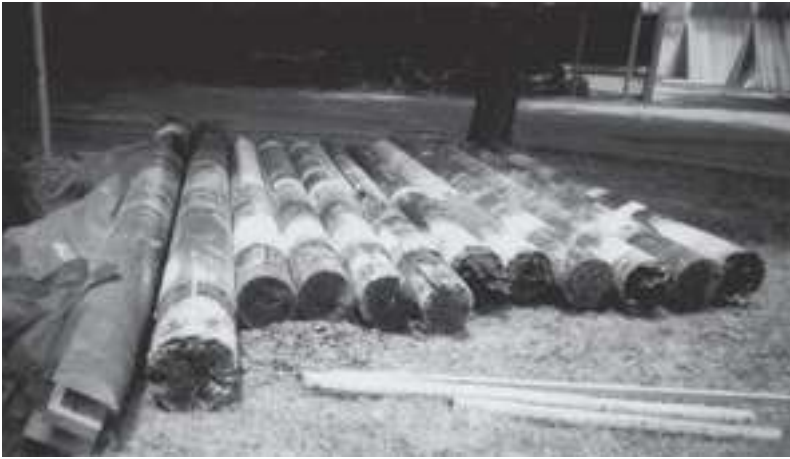
↑ 5. 園相神社の柱（平成 7 年）。底面以外の柱根は銅板で被覆されていたので、全く腐食していない。
