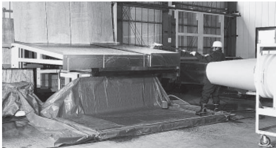
風速30m/s 降雨200mm/hの暴風雨想定試験
