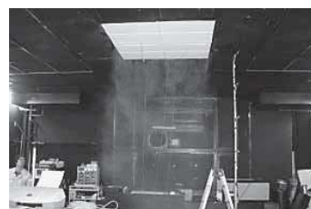
気流可視化実験（実験室）
