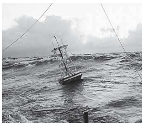
写真4 米国大気海洋庁の津波観測用ブイ (DART) (NOAAによる)
