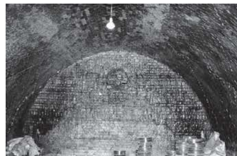
土管を焼いた常滑の角窯内部
