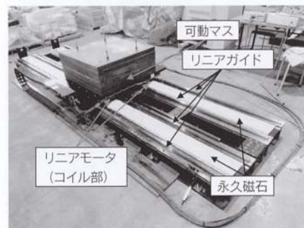
図3 リニアモータ駆動型制振装置の試験機
