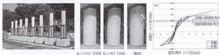
試験体と実験結果（ファイバーモデルとの比較）
