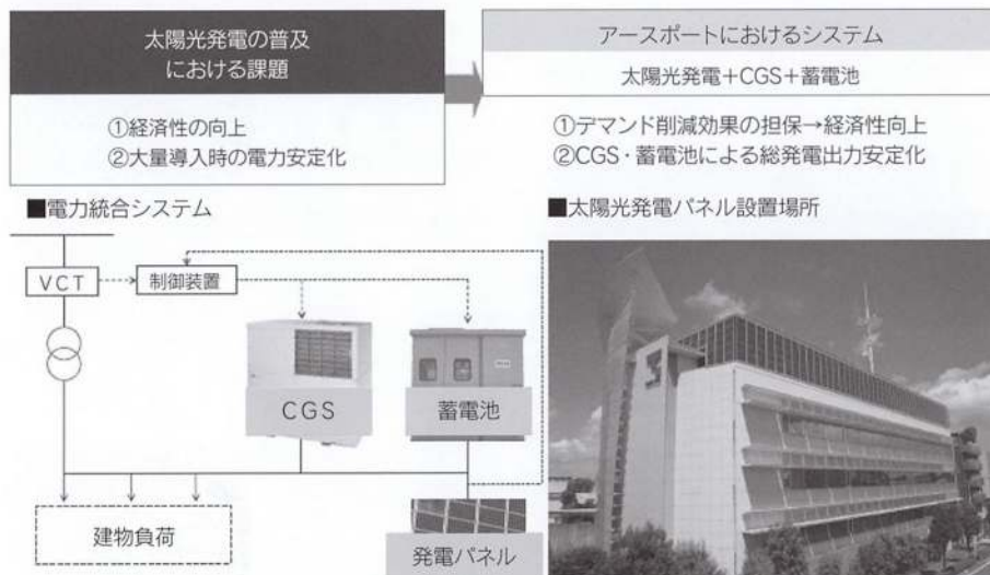
図5 電力統合制御システム概要
