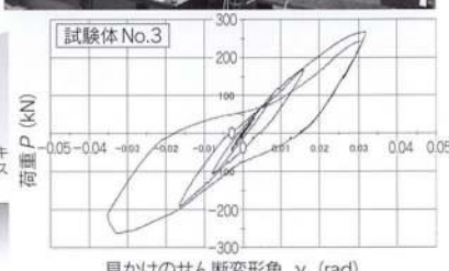
写真3 鋼板耐震壁の強度試験
