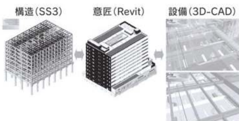
図5 意匠—構造—設備 設計におけるシームレス化
