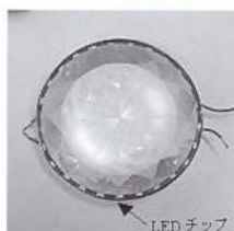
LEDの組み込み状態
