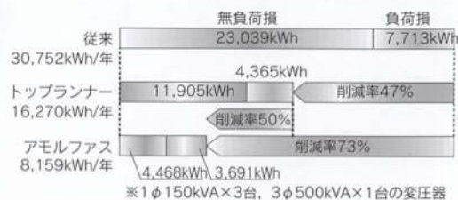
図4 変圧器エネルギー試算
