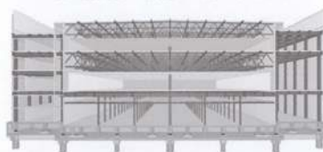
図1 免震半導体工場イメージパース
