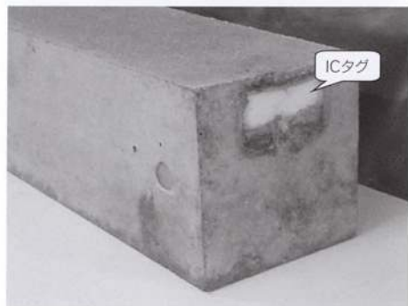
写真6 脱型後のICタグの状況
