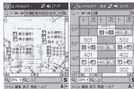
a) 図面形式 b) 表形式 図2 PDAのアイコン配置画面
