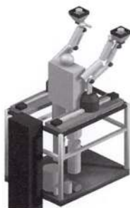
図4 パワーアシストによるアスベスト除去 イメージ
