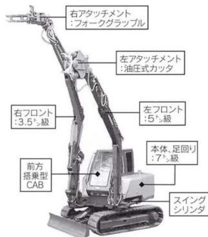
図2 双腕作業機ASTACO
