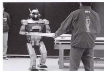
写真11 人間型ロボットと人間の協調搬送作業
