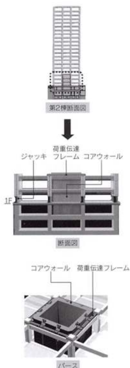
図1 コアウォールと荷重伝達フレーム
