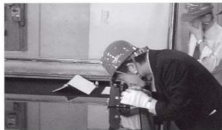
倍強度ガラスの表面圧縮応力測定
