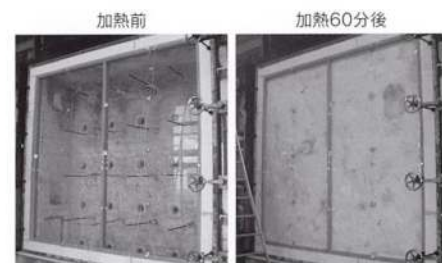
写真1・2 パイロストップの加熱実験
