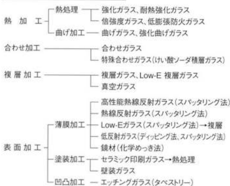
図3 板ガラスの製法と製品
