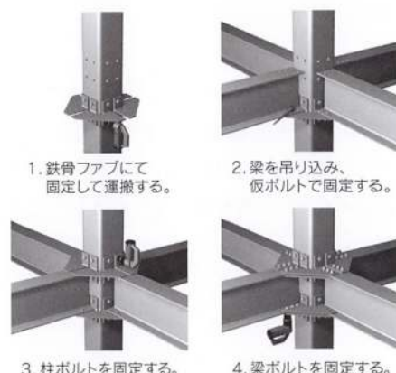
図4 ボルトによる鉄骨構造
