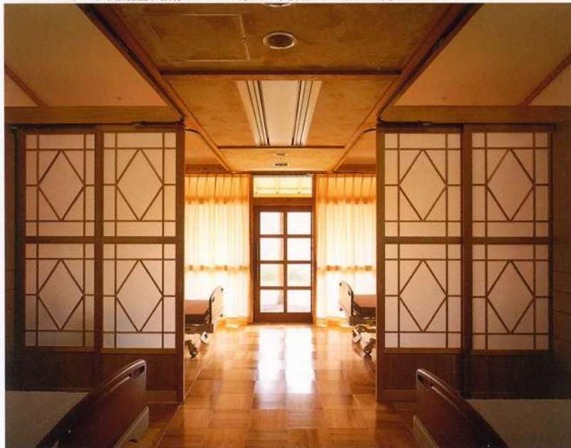
▲4床病室、可動障子で個室化し手前ベッド側にはハイサイドライト有り
