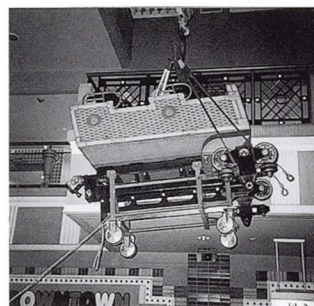
写真2 コースターの車両をメンテナンスクレーンで降ろす
