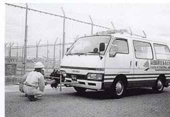
写真4 配光測定車—車両前後の測 定器により灯火の光度を測 定—
