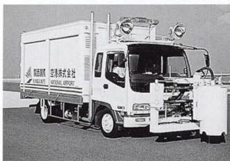
写真3 灯器洗浄車—高圧水により 埋込型灯器に付着したゴム や埃を除去—
