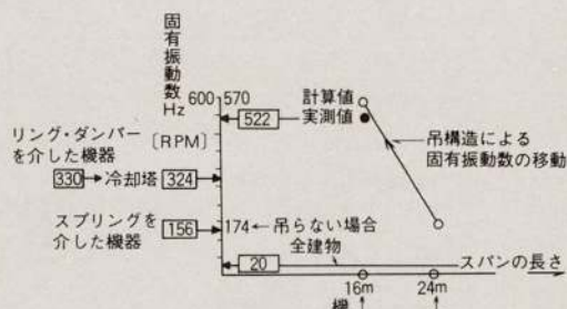
図-8 機械と構造体の固有振動数の関係
