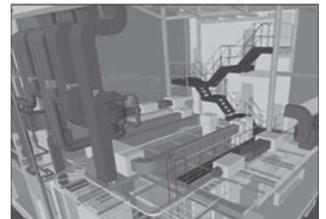
図1 BIMモデルによる配管ルート調整
