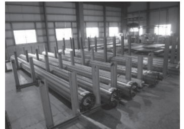
写真7 シャッターユニット工場組立
