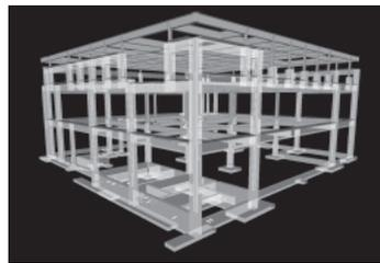
図2 BIMを用いた躯体3Dモデル
