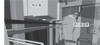
【誘引通風機室内プラント機器と有圧扇の干渉確認】
