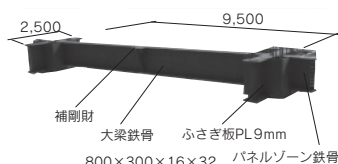
【図-2】鉄骨工場ジョイント詳細
